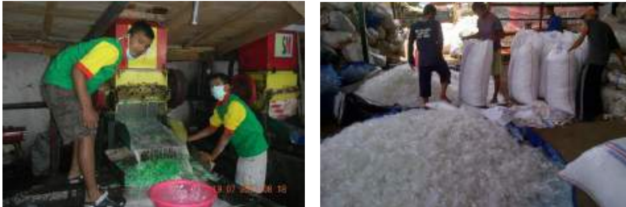
Gambar 5. Proses Pencacahan dan Pengepakan Sampah Plastik
