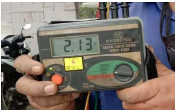
**Gambar 3.** Hasil pengujian pembumian
