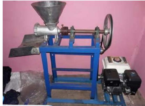
**Gambar 3.** Alat uji pembuat pellet
